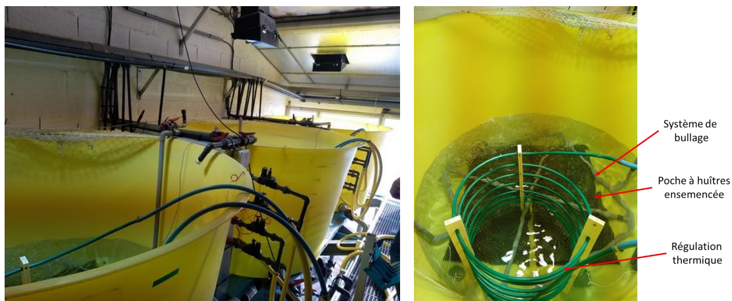
Figure 23 : Dispositif de culture en éclosier du SMEL.
