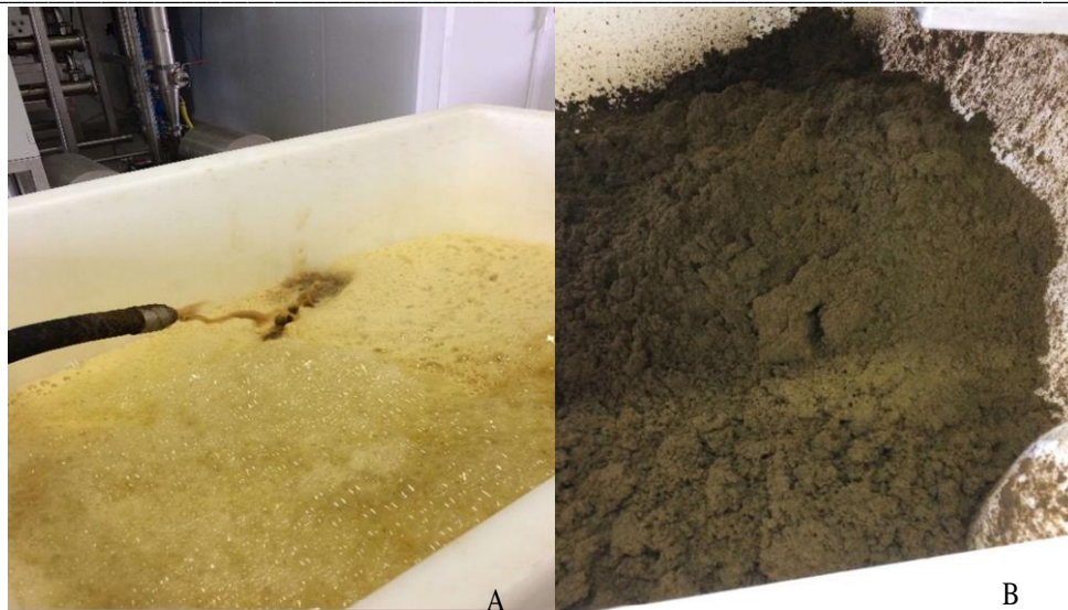
Figure 55 : Illustration de l'extrait (A) obtenu après extraction et séparation de la biomasse résiduelle (B).
