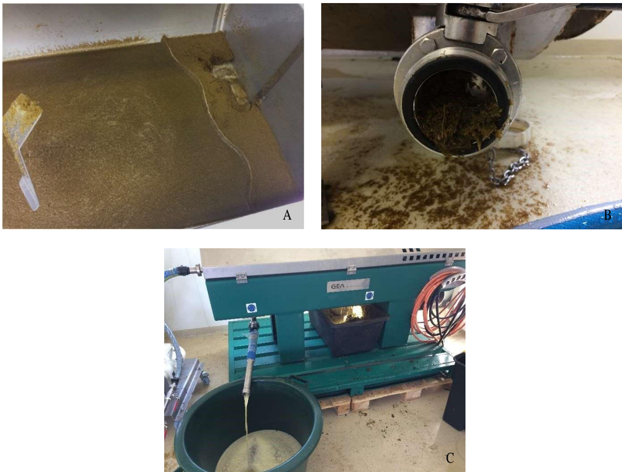
Figure 54 : Illustration du test pilote. A = cuve d'extraction, B = vidange de la cuve d'extraction, C = décanteur.
